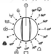
Установите селектор программ на желаемую программу: индикаторы фаз, составляющих данную программу.
